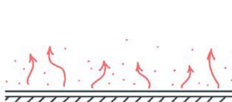
Konventionelles Dach starke Aufheizung
