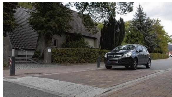
Abb. 24: Teilaufpflasterung als Querungshilfe (Quelle: Horst Troiza 2012, noz.de)
